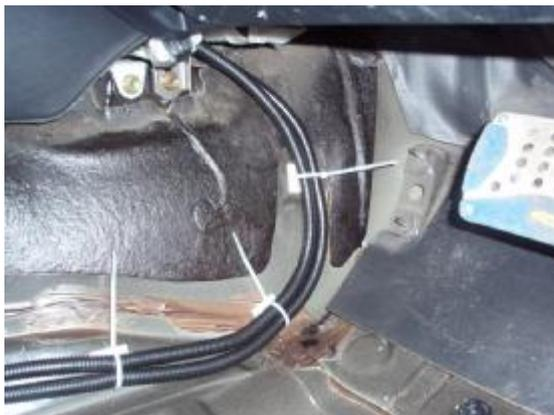
Межблочные провода защищены и закреплены.
