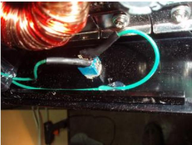
**Провода внутри корпуса закреплены с помощью термо-клея.**
