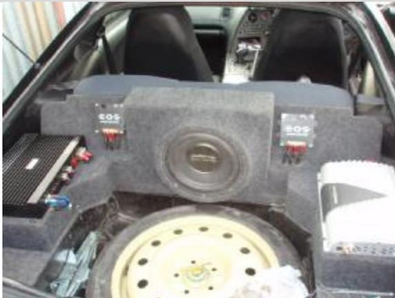
Видно, что имеется свободный доступ к запасному колесу. При этом, вынув запасное колесо, под ним получаем доступ к крышке топливного насоса, а следовательно и к самому топливному насосу.
