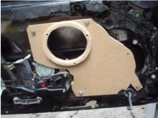
Мидбас жестко закреплен к дверной панели. Использовались 2 штатных отверстия и 2 дополнительных.
