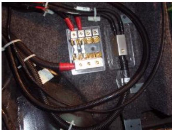
Провода, выходящие из дистрибьютора питания к усилителям, защищены и закреплены.
