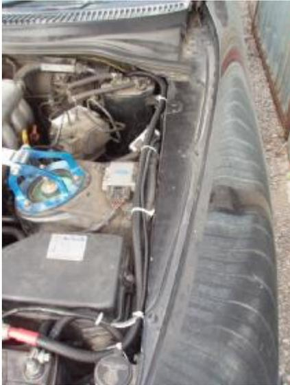
**Проводка внутри моторного отсека закреплена и защищена от внешних воздействий.**
