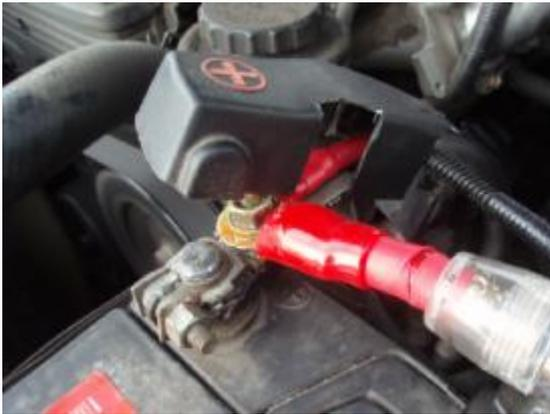
Клемма «+» аккумулятора защищена от прикосновения штатной крышкой. Контакты защищены от коррозии с помощью смазки.
