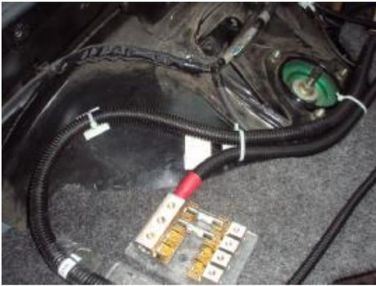
Проводка в багажнике так же закреплена. Силовой провод от АКБ подсоединяется к дистрибьютору питания.
