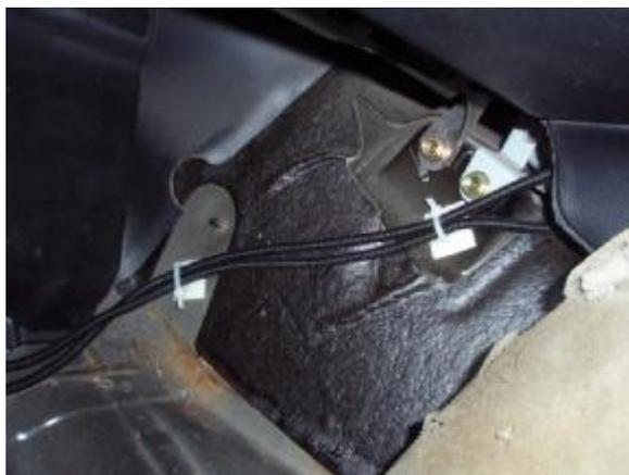
**ГУ подключено напрямую к АКБ, минуя замок зажигания. Все соединения изолированы термоусадкой и защищены гофрой.**
