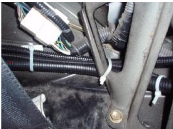
**На входе в багажник проводка так же надежно защищена.**
