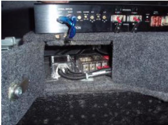
Для доступа к предохранителям на дистрибьюторе в фальш-панели сделана специальная дверца, закрывающаяся на ключ.
