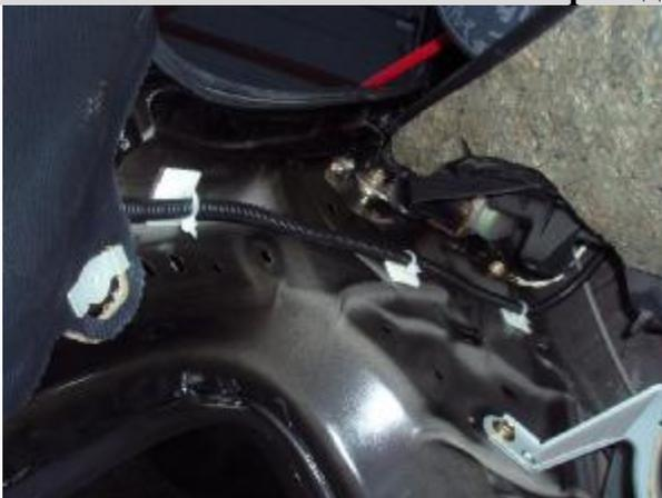
**Проводка твиттеров поднимается из багажника к крыше по задней стойке стекла...**
