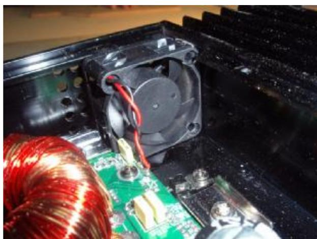
На усилителе установлен штатный вентилятор охлаждения.
