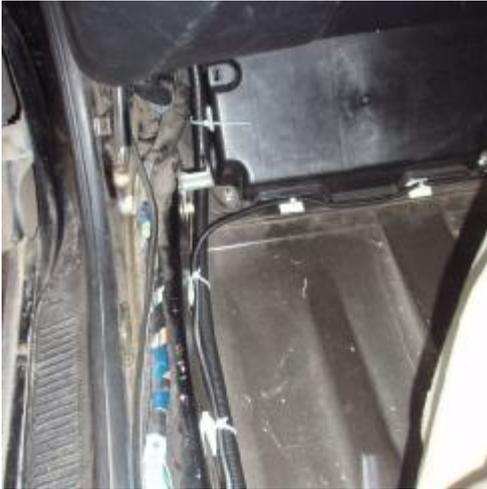
**Силовой кабель проложен по порогу и закреплен, согласно правилам, не более, чем через 25см.**
