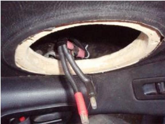
**Концы проводов заканчиваются клеммами и защищены.**
