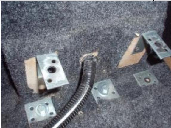
**Внутри сабвуфера проводка входит без использования клемм. Провод проходит через дерево и закреплен в нем герметиком.**
