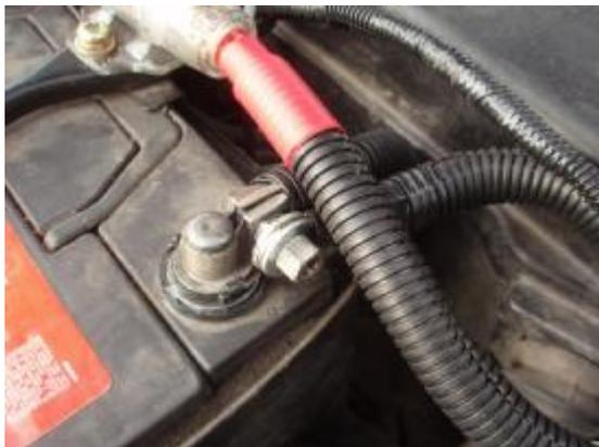
Проложен дополнительный провод заземления.
