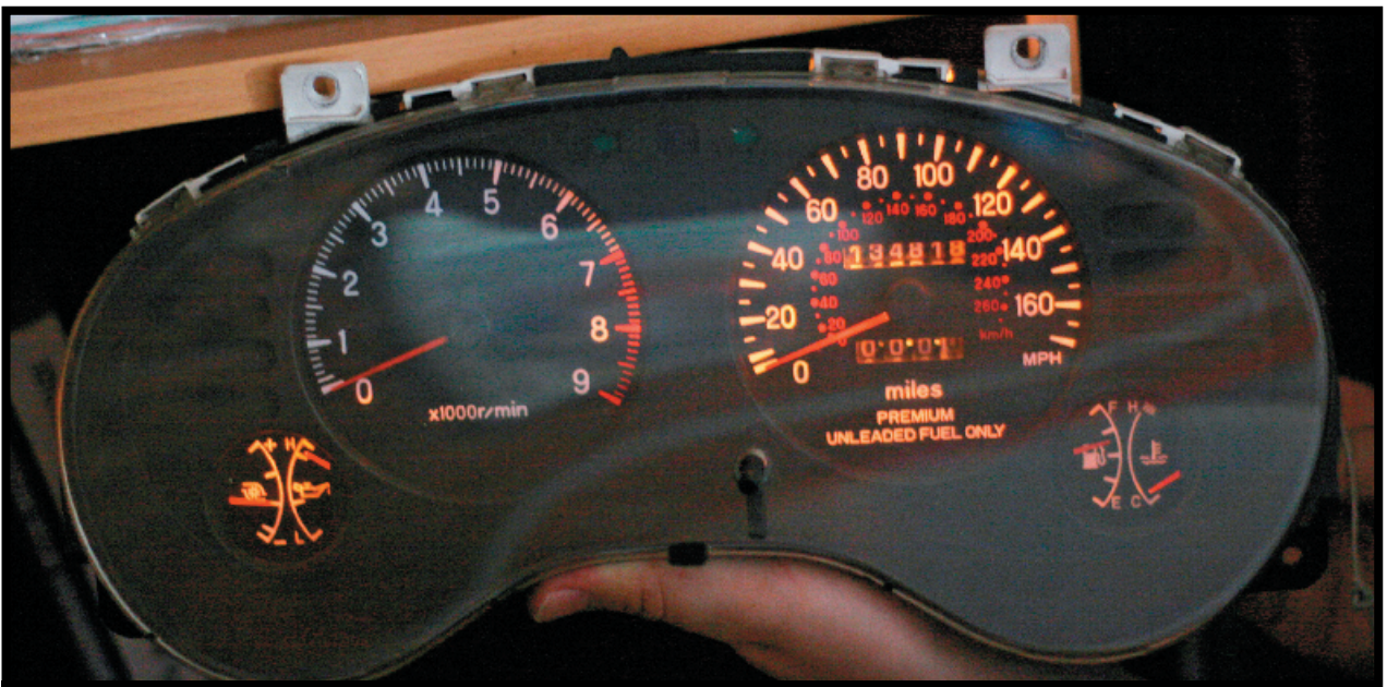
1 Желание сменить подсветку комбинации приборов вызвано разными причинами. Бывает уважительный вариант – заводская светит не ярко или, как в нашем случае, уже потускнела с возрастом. Но чаще хочется изменить цвет подсветки и сделать ее покруче. К счастью, в наше время RGB-диоды уже достаточно распространены и дешевы. Благодаря им мы сможем поэкспериментировать с цветом комбинации приборов. За работу выражаем благодарность Роману из клуба www.dsm-club.org (ник на форуме – MMC G4)
