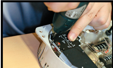
23 В обратном порядке собираем приборку. Прозрачную крышку не одеваем – так как все стрелки, кроме спидометра и тахометра, нужно будет корректировать после подключения. Стрелку бензина выставляем, заправив полный бак, а остальные – после прогрева двигателя
