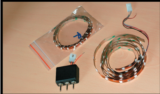
2 Были куплены два набора smd-диодов (имеют сверхяркое свечение): красные и RGB-диоды. Также, благодаря подсказке Dimon311 из Calibra-club был собран простенький контроллер для управления цветом в цепи RGB-диодов. В качестве проводки мы взяли обычную компьютерную шину для подключения внешних устройств. И, конечно же, для работы нам понадобится паяльник
