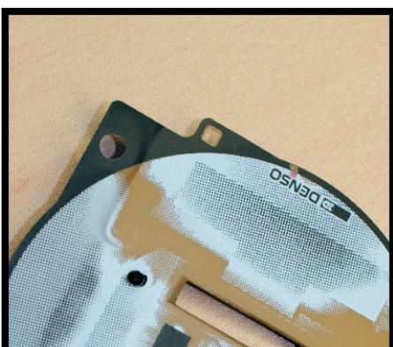
8 С обратной стороны на шкалу нанесено несколько рассеивающих слоев, которые необходимы для правильного отображения цвета заводских лампочек, но испортит всю малину в случае применения светодиодов
