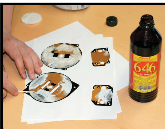
9 Поэтому берем растворитель и стираем всю полупрозрачную матовую гадость. Главное, чтобы растворитель не попал на лицевую сторону шкал – иначе их можно испортить
