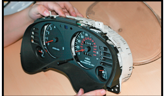
3 После снятия приборки с автомобиля (в Mitsubishi Eclipse 2G она крепится на четырех болтах) ее надо полностью разобрать. Сначала снимаем прозрачную крышку (держится на защелках), а затем и основной корпус
